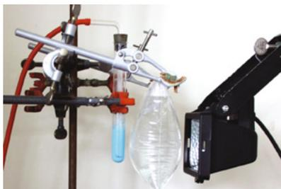
**B2** Versuchsaufbau zu V2 und V3. Das Kühlwasser im Plastikbeutel lässt die UV-Anteile des Lichts durch.
