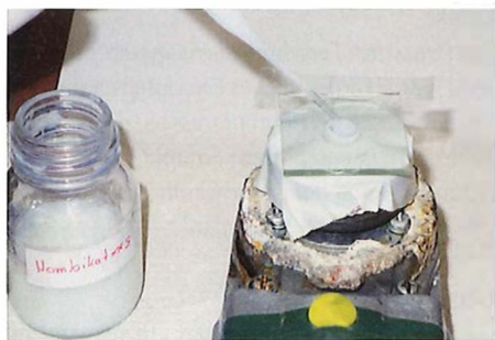
Abb. 5: Auftragen der Titandioxid-Suspension für das Spincoating
