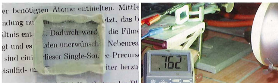
Abb. 8: Die Solarzelle aus Versuch 3 ist transparent (links) und photosensibel (rechts Spannungsmessung).
