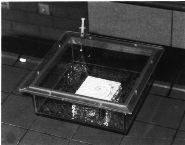
Abb. 10: Selbstgebafter Reaktor  $30 \times 30 \times 10 \text{ cm}^3$  mit abschraubbarem Plexiglasdeckel, Magnetrührer und zwei Silicon-Fittings zum Eindosieren der Spurengase
