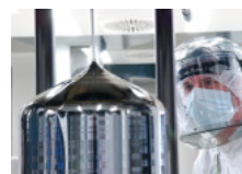
B3 Rohsilicium und ein-kristallines Reinstsilicium. A: Wie züchtet man perfekte Kristalle?
