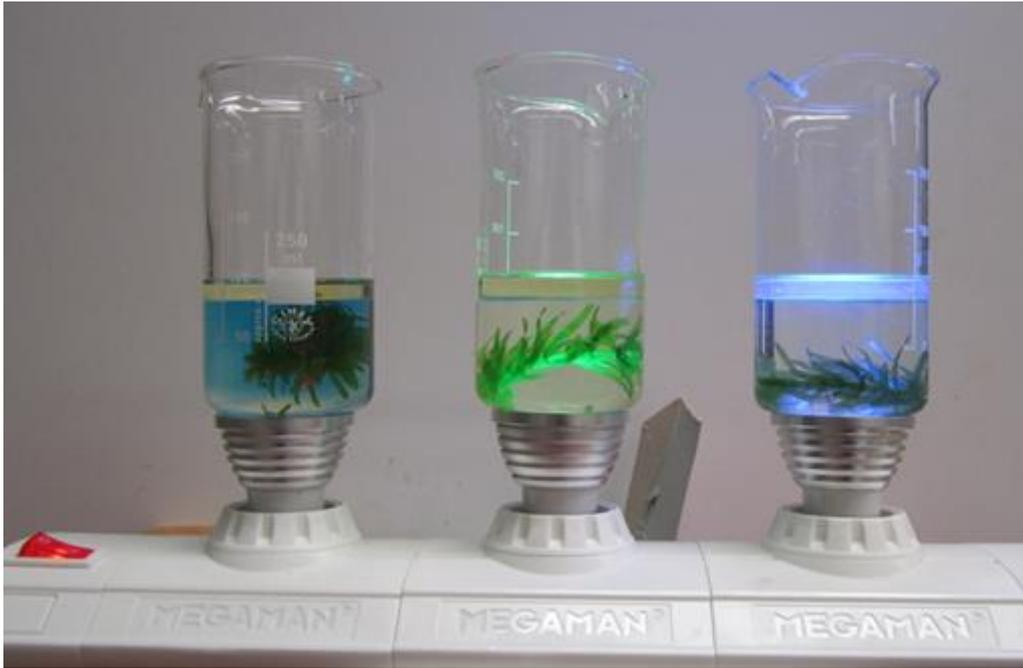
**Beobachtung:** Bei Bestrahlung mit blauem und rotem Licht tritt früher eine Blaufärbung auf als bei Bestrahlung mit grünem Licht.
