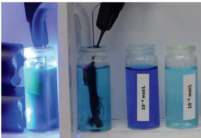
**B12** Photoelektrochemische Reduktion von Methylenblau. Der Versuchsaufbau ist ähnlich zu dem in B10 skizzierten.
