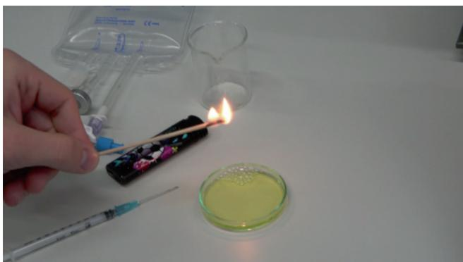
**B11** Versuchsaufbau zur modifizierten Knallgasprobe
