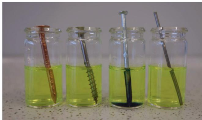
**B9** PBB-Lösung mit folgenden Metallen: Kupfer, Edelstahl, Zink, Nickel (v.l.n.r.)
