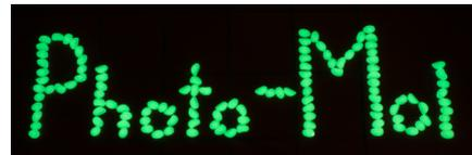
Phosphoreszenz von Fluorescein in einem Kunststoff
