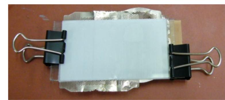
Kompaktzelle mit  $\text{TiO}_2$
