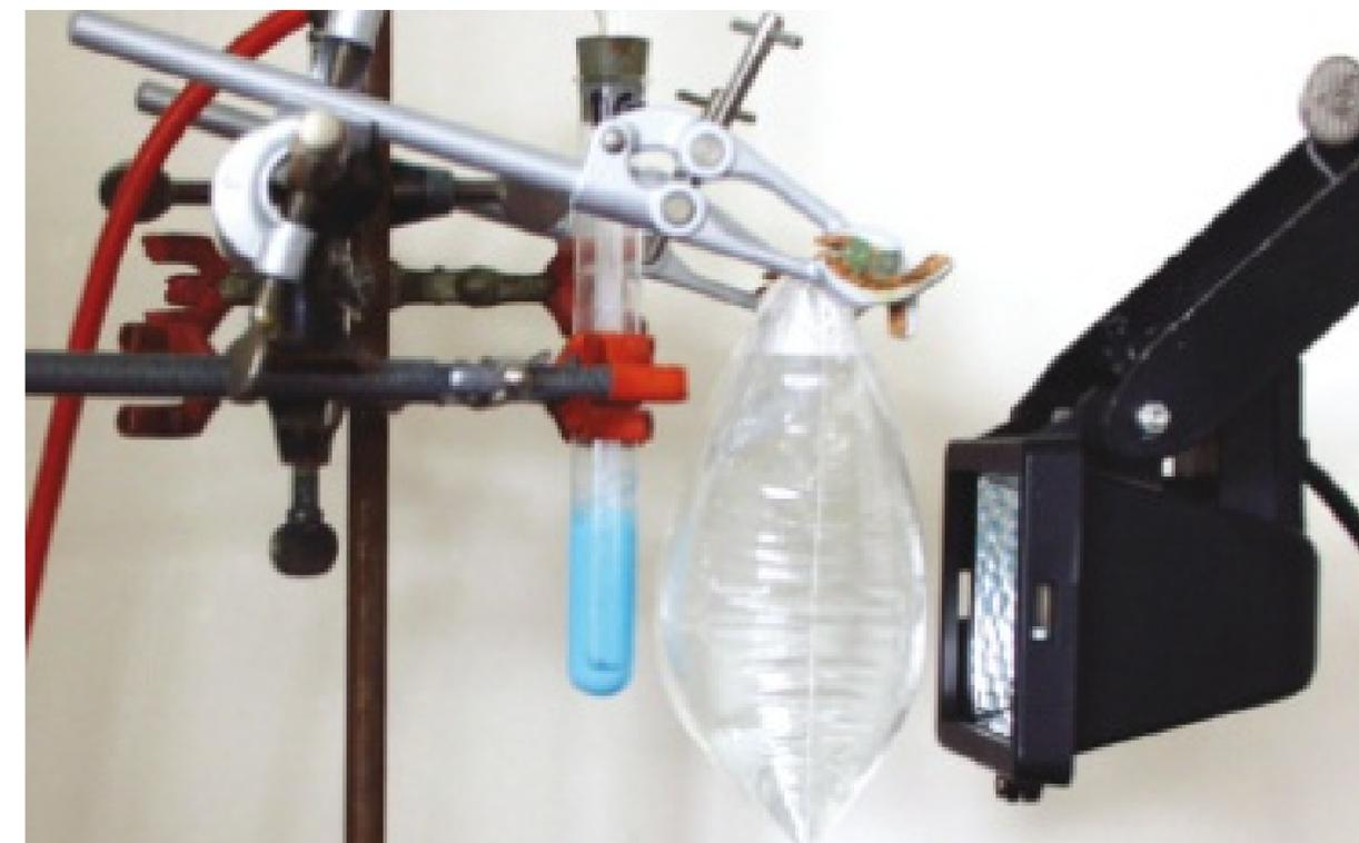
Methyleneblau-Reduktion und Oxidation
