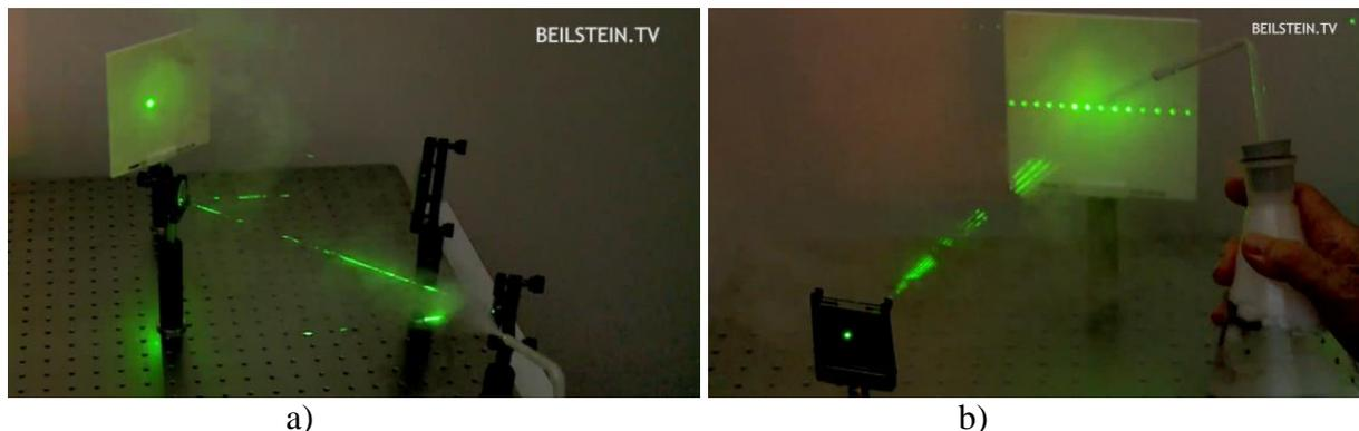
Abb. 3: a) Experiment zur Reflexion eines Laserstrahls aus grünem Licht; b) Experiment zur Beugung und Interferenz eines grünen Laserstrahls; (Screenshots aus dem Film: <https://chemiemitlicht.uni-wuppertal.de/de/filme-videos/einfuehrende-videos/was-ist-ein-photon/>; (© M. W. Tausch et al.)
