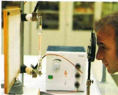
**B 410.1.** Linienspektrum des Wasserstoffs und Versuchsaufbau zu seiner Erzeugung
