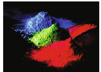
B6 Anorganische Leuchtstoffe [blau: \text{BaMgAl}_{10}\text{O}_{17}(\text{Eu}^{2+}) , grün: \text{CaMgAl}_{11}\text{O}_{19}(\text{Tb}^{3+}) , rot: \text{Y}_2\text{O}_3(\text{Eu}^{3+}) ]. Die in Klammern angegebenen Ionen sind nur in Spuren enthalten. A: Geben Sie die Positionen dieser Elemente im Periodensystem an.
