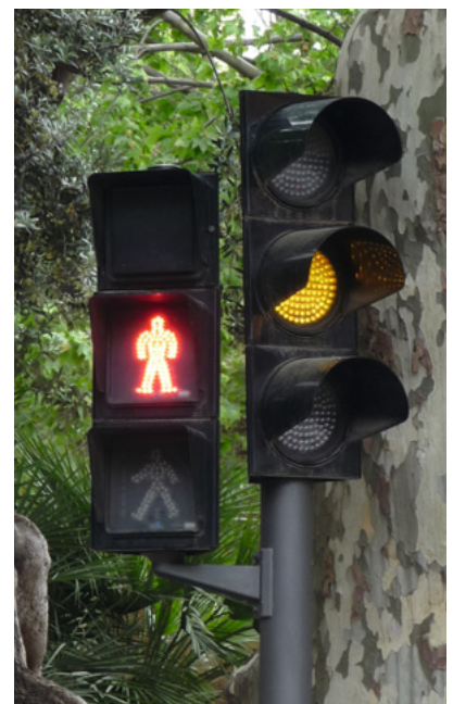
B6 Verkehrsampel mit LEDs. A: Nennen Sie Vorteile, die der Einsatz von LEDs in Ampeln gegenüber herkömmlichen Glühlampen bringt.
