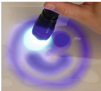
B2 Auf eine „intelligente Folie“ (photochrome Folie) kann mit einer LED-Taschenlampe gezeichnet oder geschrieben werden.
